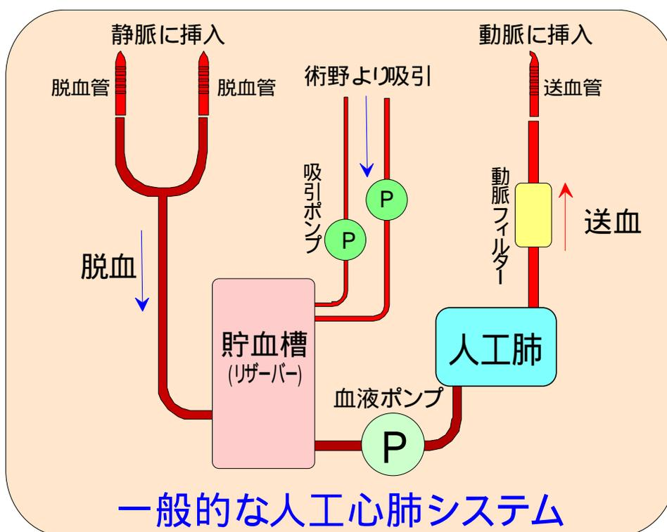
これらの人工心肺システムは、患者の右心房に還流する静脈血を、脱血管という特殊なチューブ（通常カニューレと呼ばれ、血管と血液回路との接手となる）を血管内に挿入し、血液回路を通して貯血槽に貯留させる。貯血槽に貯まった静脈血を血液ポンプで人工肺に送り込み、酸素化し炭酸ガスを排出させた後、動脈血として患者の動脈に送血する。必要な灌流量は患者の体格に合わせる必要がある。体表面積 1 m<sup>2</sup>あたり 2.2 ~ 2.6L/min、成人では 3500 ~ 4500mL/min で灌流される。
